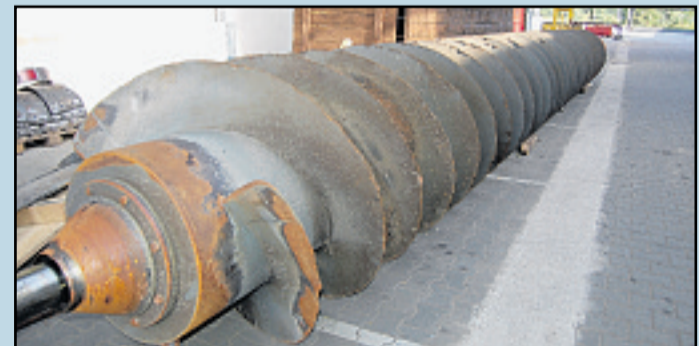
Da gibt es noch einiges zu regenerieren und hartplattieren. Fotos: Tippl (2), Fa. Rehart (1)
