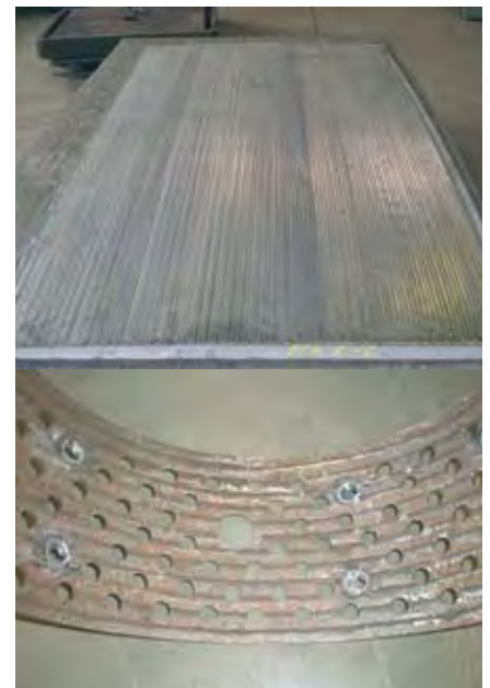
Komplett gepanzerte Blechtafel Format 1500 mm x 3000 mm (oben); Gepanzertes Lochblech (unten).
