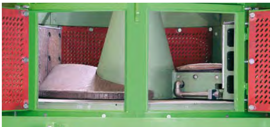
Durch die Anordnung der Siebe in ausschwenkbaren Siebbögen können diese einfach ausgetauscht werden.
