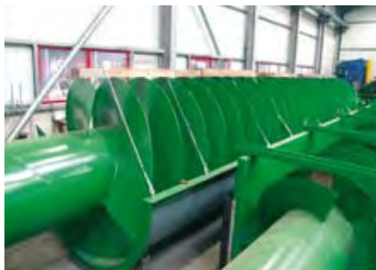
Die Wasserschnecke und der dazugehörige Trog wurden in Ehingen hergestellt und dann nur noch am Rande des Englischen Gartens eingebaut.
