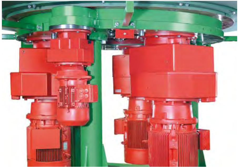
Über einen Zahnkranz treiben die drei Motoren den Rührarm an.
