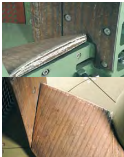
Der auf dem Rührarm angebrachte Verschleißschutz lässt sich einfach auswechseln.
