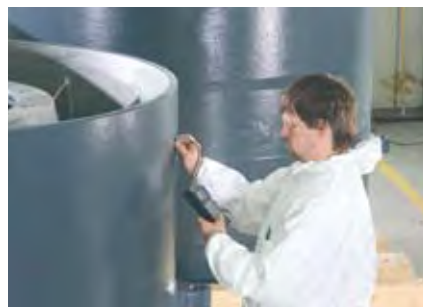
Leiträder: Schichtdickenmessung bei der Endkontrolle.
