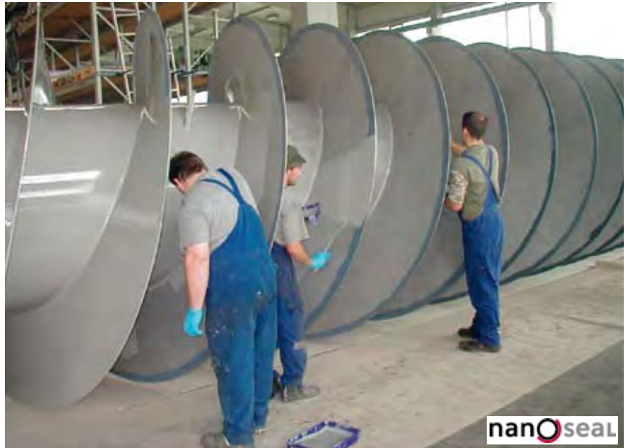
Der Keramikverbundwerkstoff nanoseal kann einfach mit einer Rolle aufgetragen werden.
