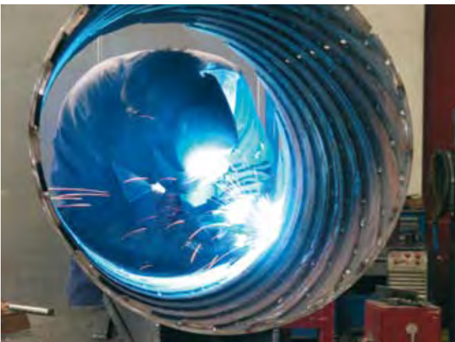
Aufgeschweißte Verbundpanzerplatten helfen gegen Verschleiß.
