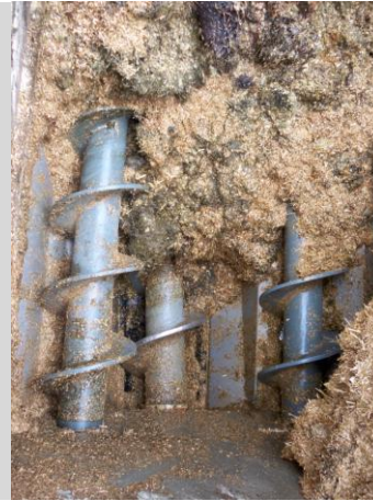
Mischschnecke gepanzert und beschichtet
