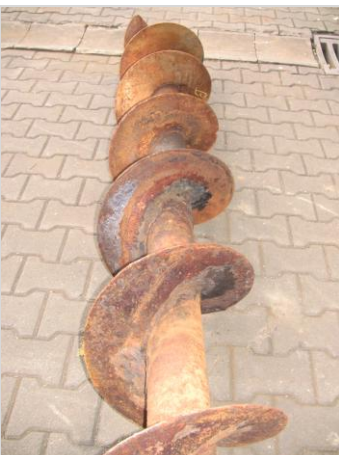
Stopf-/ Steigschnecke für Biogasanlagen, verschlissen
